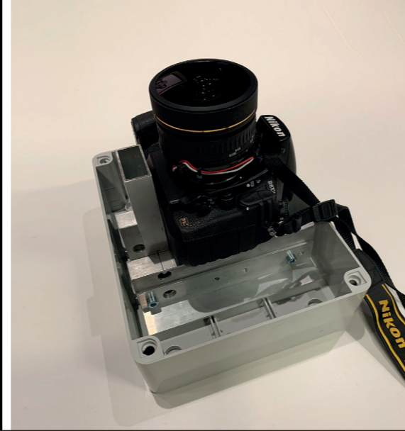
Figuur 9. De allsky-camera's in het netwerk zijn volgens een standaard concept gebouwd. Full frame-camera met 8 mm fisheye-lens en ingebouwde LCD-shutter. (Marco Verstraaten)
