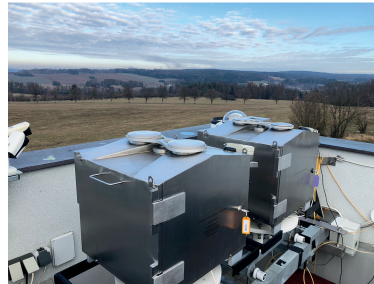
Figuur 2. Twee DAFO-opstellingen op het meteorenobservatorium te Kunzak, Tsjechische republiek. De objectieven zijn overdag met kappen afgesloten. (Hans Betlem)
