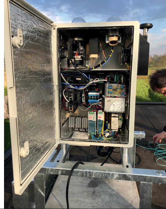
Figuur 6. Kijkje in de kast van de high speed -fotometer te Winterswijk-Woold. Linksboven de fotomultiplier, rechts de videocamera. Computers en randapparatuur vinden hun plekje in het onderste deel van de kast. Rechtsboven de GPS-antenne. (Hans Betlem)
